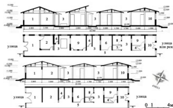
Рис. 8. Планы и разрезы «соузинляо» с тремя и двумя дворами: 1 – магазин / прихожая; 2 – гостиная; 3 – двор; 4 – туалет; 5 – проход; 6 – столовая; 7 – кладовая; 8 – кухня; 9 – спальня; 10 – хозяйственный двор
