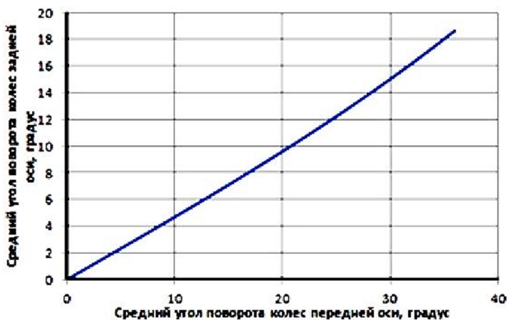
Рис. 2.11. Зависимость среднего угла поворота колес задней оси от среднего угла поворота колес передней оси
