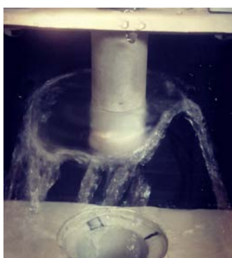
Рисунок 2 – Струя электролита, формируемая на выходе из электрода-инструмента
