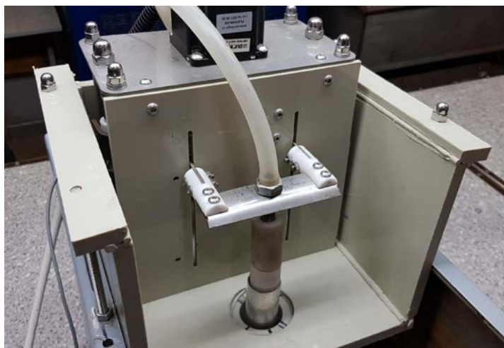
Рисунок 1 – Внешний вид оборудования для получения МДО покрытий на внутренних поверхностях трубчатых изделий
