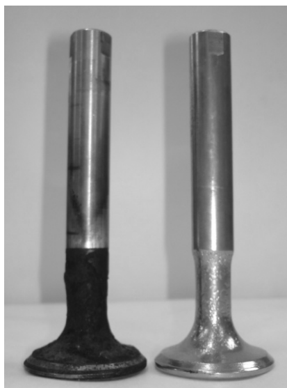
Рисунок 1 – Внешний вид клапана двигателя внутреннего сгорания до (слева) и после обработки (справа) комбинированным методом очистки-полирования
