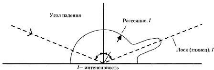
Рис. 57. Принцип измерения лоска (глянца) бумаги и картона
