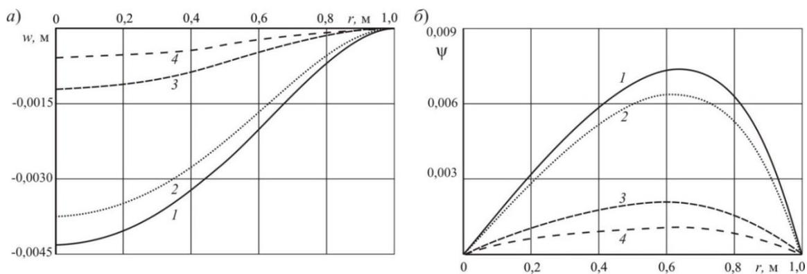
Рис. 3. Изменение прогиба  $w$  и сдвига в заполнителе  $\psi$  вдоль радиуса пластины
