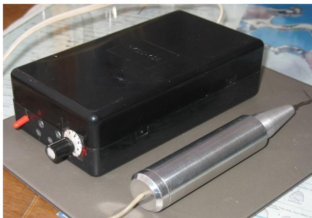
Рис. 1. Модель генератора и наконечника для низкочастотных продольных и поперечных ультразвуковых колебаний
