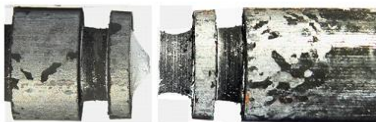
Рис. 7. Вид излома образца типа «gr» и деформированных зон, примыкающих к излому
