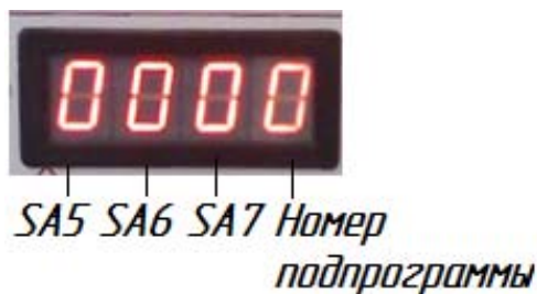
Рис. 1.10. Соответствие тумблеров SA5–SA7 разрядам светодиодного четырехсегментного индикатора.
