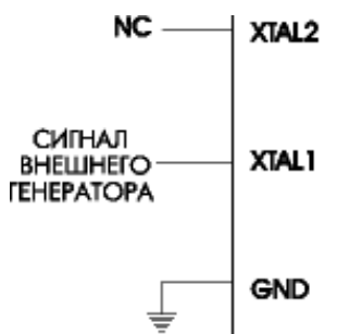
Рис. 3.2. Подсоединение внешнего источника тактового сигнала
