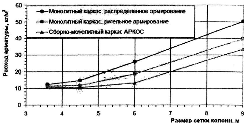
График 1. Относительный расход арматурной стали на армирование монолитных и сборно-монолитных каркасов
