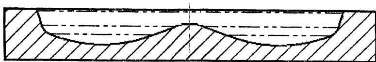
Рисунок – Камера сгорания высокофорсированного дизеля
