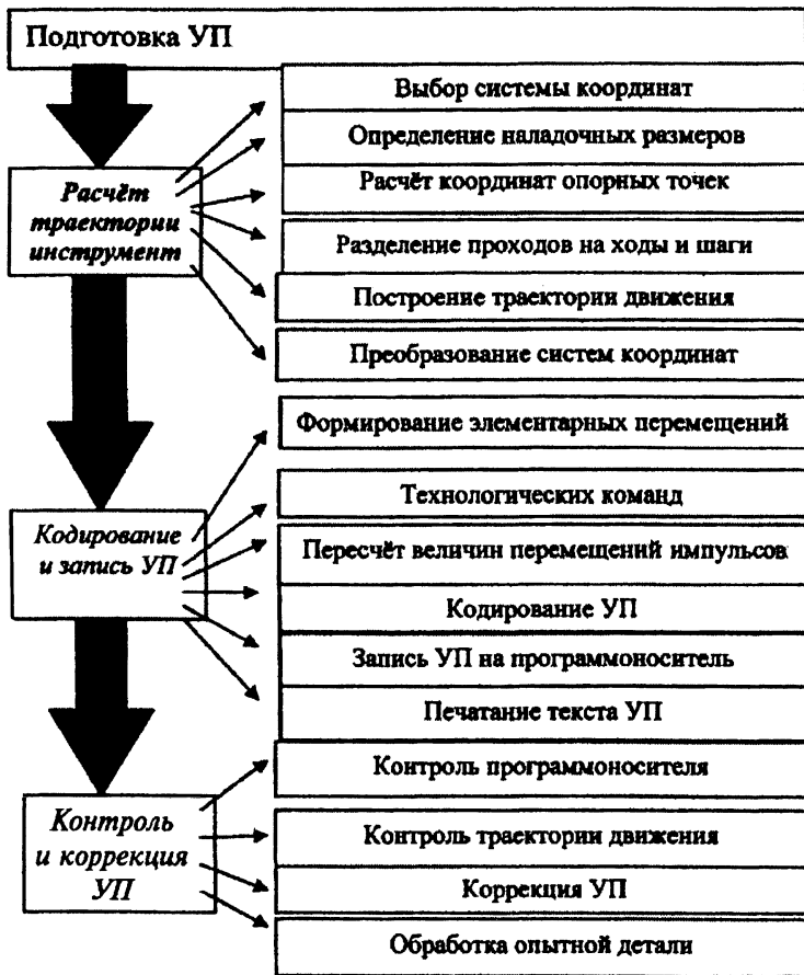
Рис. 1. Последовательность составления управляющей программы для станков с ЧПУ
