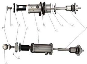
Рисунок 2 – Устройство приводов вращения
