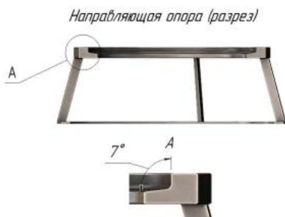
Рисунок 3 – Направляющая опора
