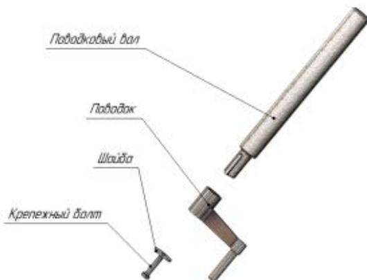
Рисунок 1 – Поводковый вал
