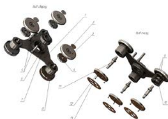
Рисунок 2 – Подложкодержатель: 1 – корпус; 2 – прижимная шайба; 3 – ролик; 4 – крышка стакана; 5 – ограничители; 6 – стакан; 7 – подшипник; 8 – стакан; 9 – подшипники; 10 – втулка; 11 – вал; 12 – держатель; 13 – подложкодержатель
