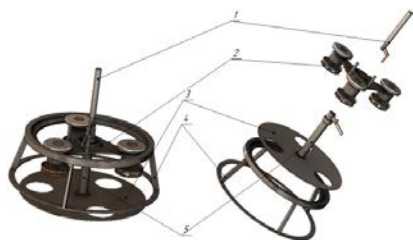
Рисунок 1 – Общий и разнесенный вид планетарной технологической оснастки: 1 – поводковый вал; 2 – подложкодержатель; 3 – заслонка; 4 – направляющая опора; 5 – вал заслонки
