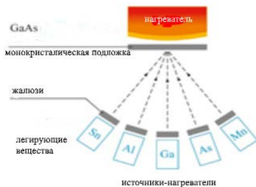
Рисунок 1 – Схема напыления на подложку
