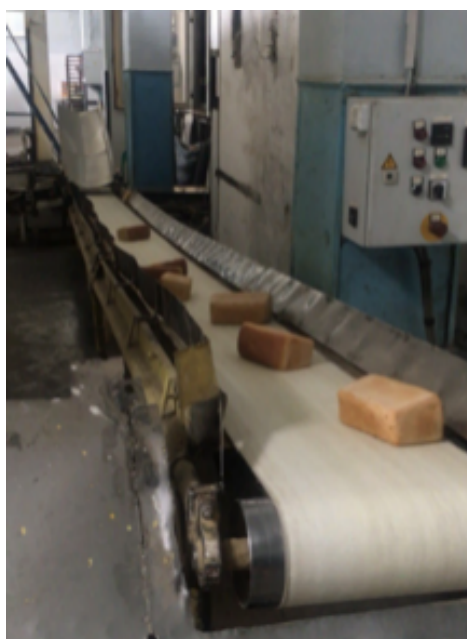
Рисунок 1 – Общий вид поточной транспортерной системы хлеба
