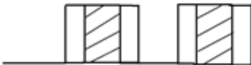
图 1 PPM 双电磁阀控制信号原理图
