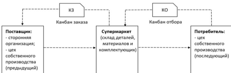
Рис. 1. Схема функционирования канбан отбора и канбан заказа
