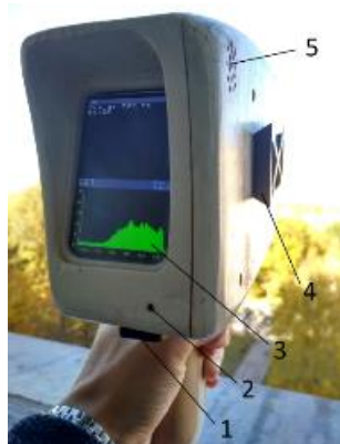
1 – порт для программирования; 2 – индикатор записи видео; 3 – регистрируемый спектр на экране; 4 – кронштейн крепления DEVI к штативу; 5 – расположение датчика атмосферных параметров
