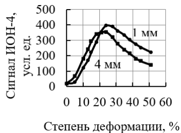
Рисунок 4 – Зависимость сигнала прибора ИОН-4 от степени деформации при толщинах образцов 1 и 4 мм
