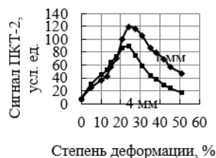
Рисунок 4 – Зависимость сигнала прибора ПКТ-2 от степени деформации при толщинах образцов 1 и 4 мм
