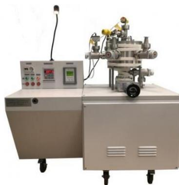
Рисунок 1 – Общий вид установки вакуумметрической эталонной 2-го разряда УВЭ-3
