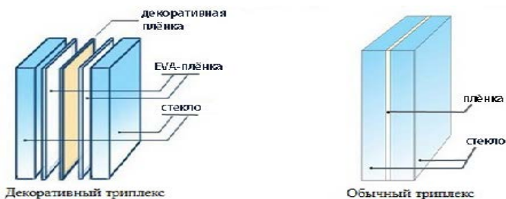
Рисунок 1 – Схема стекла триплекс
