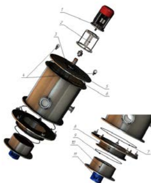
Рисунок 3 – Монтаж составных элементов вакуумной камеры: 1 – электродвигатель; 2 – кронштейн; 3 – рельефный фланец; 4 – рым-болты; 5 – крышка; 6, 7 – уплотнения; 8 – днище; 9 – уплотнение магнетрона; 10 – магнетрон; 11 – кожух
