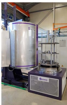
Рисунок 2 – Ярусная загрузка деталей в камере с горячими стенками
