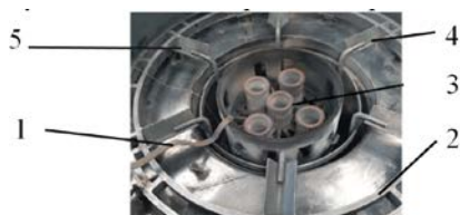
Рисунок 2 – Фотография установленной оснастки в камере: 1 – металл-шина; 2 – катод-опорная плита; 3 – корзина с деталями; 4 – стяжка; 5 – ключичина
