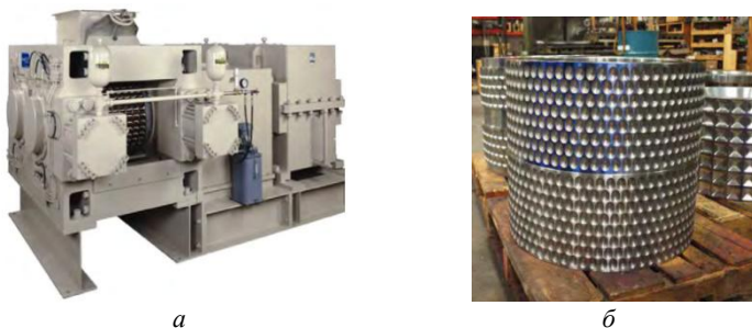
Рисунок 1 – Общий вид валкового брикетировочного пресса (а) и поверхность валков (б)
