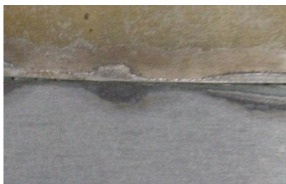
Рисунок 2 – Внешний вид листовых материалов, использованных для соединения листовых материалов (пластин) цилиндрической ( a ) и прямоугольной формы ( б ), сложенных по схеме «стальной лист/листовой алюминий/стальной лист», после их совместной пластической деформации методом прессования с последующей термической обработкой ( в )
