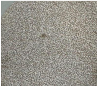
Рисунок 2 – Эвтектические зерна немодифицированного ( a ) и модифицированного FeSiBa ( б ), модифицированного FeSiBa + выд. 15 мин ( в ), модифицированного FeSiBa + лигатура ( г ), модифицированного FeSiBa + лигатура + выд. 15 мин ( д ) серого чугуна
