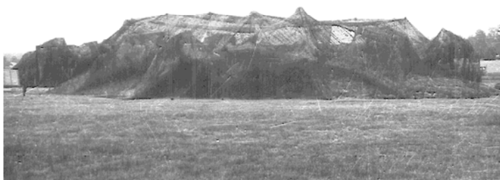
Рис. 1.3. Маскировка самолета комплектом маски «Зонт-1»
