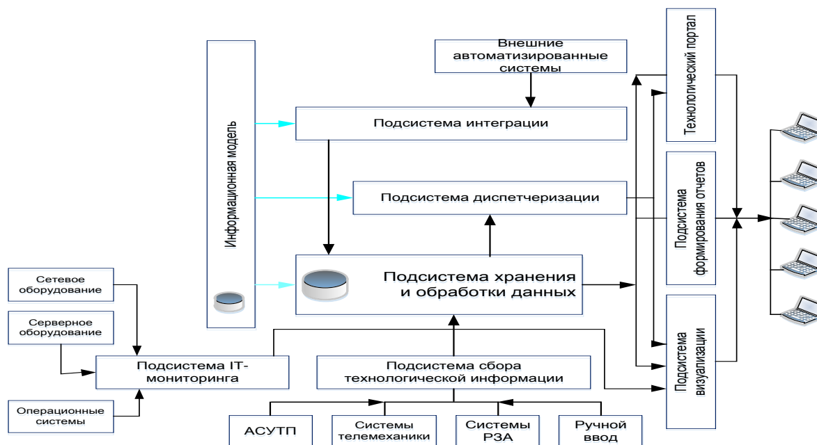
Рис. 1. Функциональная схема интеллектуальной системы управления распределительных сетей напряжением 10 кВ
