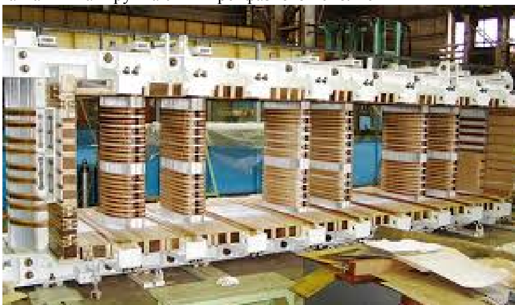
Рисунок 2 – Магнитная группа УШР трёхфазного исполнения
