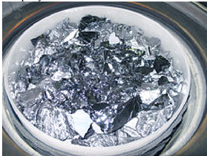
Рисунок 3 – Тигель, заполненный шихтой
