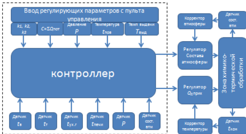
Рисунок 3 – Функциональная схема регулирования тепловой нагрузки и состава атмосферы зоны топливной печи химико-термической обработки
