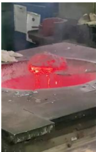
Рисунок 2 – Внешний вид шлаковой фазы в процессе ее отбора из металлургической печи ( a ) и слитков сплавов на основе алюминия ( б ) с содержанием кремния 8–11 % (мас.), полученных после металлургической переработки алюмоматричных кварцсодержащих композиций на основе системы Al/SiO_2
