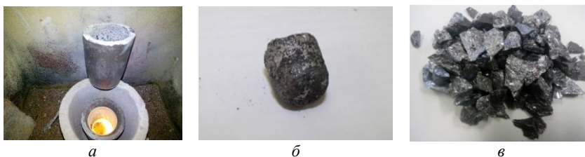
Рисунок 5 – Основные этапы получения слитка сплава Ni-Cr-Si металлотермическим восстановлением с последующим измельчением: а – металлотермическая восстановительная плавка; б – полученный слиток; в – сплав после измельчения
