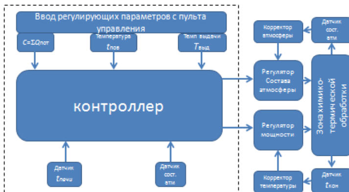
Рисунок 6 – Функциональная схема регулирования тепловой нагрузки и состава атмосферы зоны электрической печи химико-термической обработки
