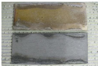
Рисунок 2 – Внешний вид листовых материалов, использованных для соединения листовых материалов (пластин) цилиндрической ( a ) и прямоугольной формы ( б ), сложенных по схеме «стальной лист/листовой алюминий/стальной лист», после их совместной пластической деформации методом прессования с последующей термической обработкой ( в )
