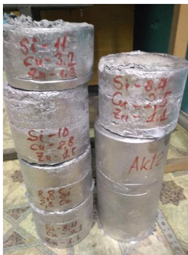
Рисунок 2 – Внешний вид шлаковой фазы в процессе ее отбора из металлургической печи ( a ) и слитков сплавов на основе алюминия ( б ) с содержанием кремния 8–11 % (мас.), полученных после металлургической переработки алюмоматричных кварцсодержащих композиций на основе системы Al/SiO_2
