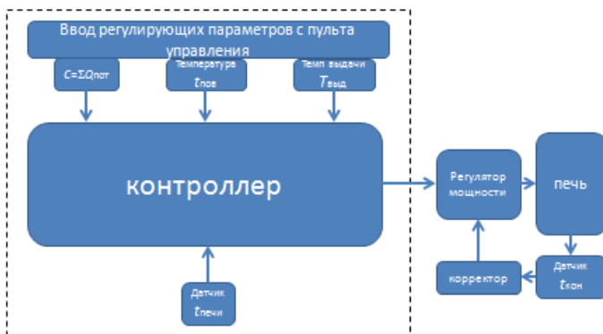
Рисунок 4 – Функциональные схемы регулирования тепловой мощности однозонной электрической термической печи
