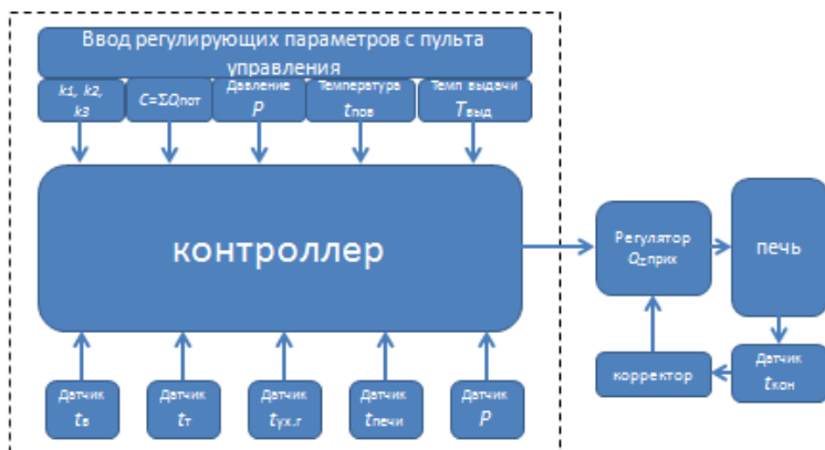
Рисунок 1 – Функциональная схема регулирования тепловой нагрузки однозонной (камерной) топливной термической печи
