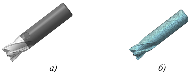
Рисунок 1 – 3D–модель фрезы (а) и конечно-элементная сетка (б)
