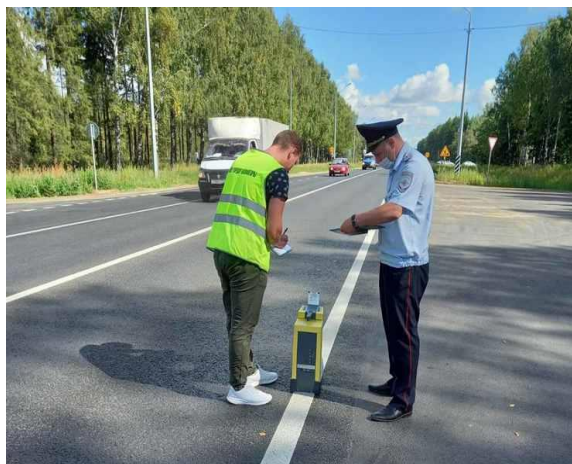
Рис. 3. Проверка состояния разметки
