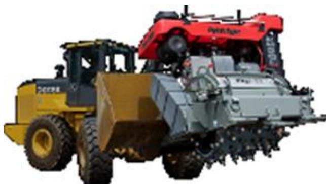
Рис. 2. Навесная фреза Asphalt Zipper AZ-360B к погрузчику
