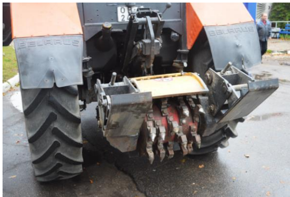
Рис. 7. Машина фрезерная ДЭМ-121 производства СП «Дорэлектромаш»
