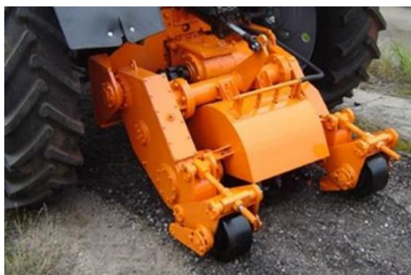
Рис. 6. Фреза дорожная, HO-83 производства ОАО «Белдортехника»
