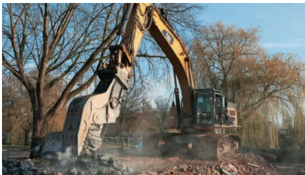
Рис. 8. Гидравлический измельчитель бетона P215 компании «Caterpillar» к гидравлическим экскаваторам
