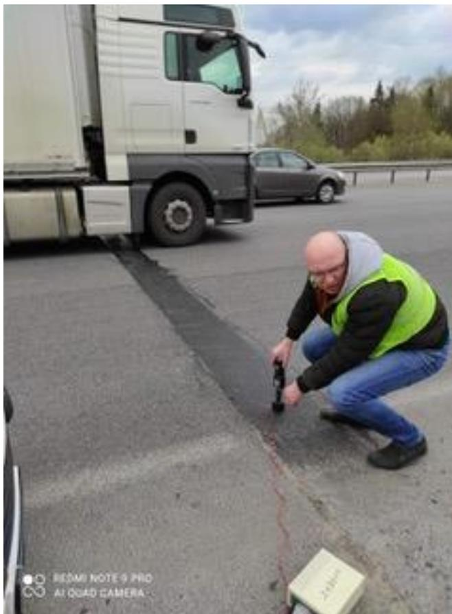
Рис. 4. Исследование с помощью прибора ИПМ -1 деформационных характеристик
