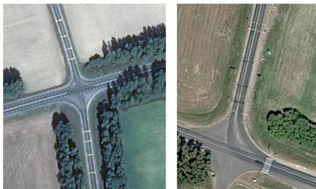
Рисунок 1 – Пример решения, заменяющего кольцевое пересечение малого радиуса (видны искусственные неровности, расположенные одна за другой)
