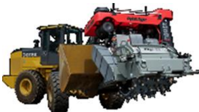
Рис. 2. Навесная фреза Asphalt Zipper AZ-360В к погрузчику
