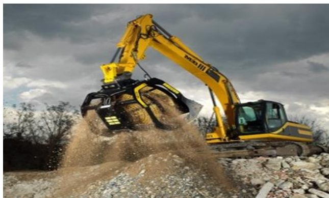
Рис. 10. Просеивающий ковш серии MB-S
