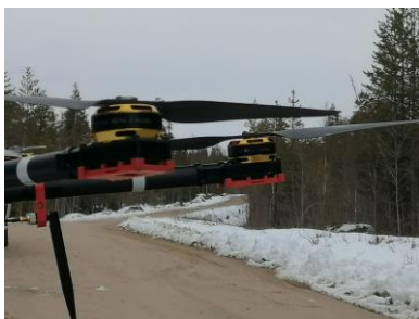
Рис. 1. Беспилотный летательный аппарат при изыскании дороги
