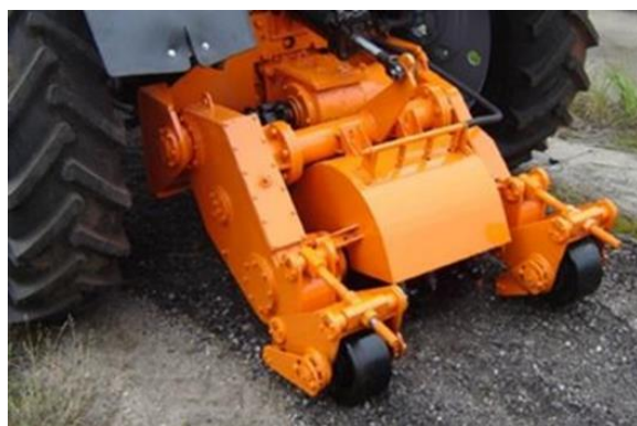
Рис. 6. Фреза дорожная, HO-83 производства ОАО «Белдортехника»
