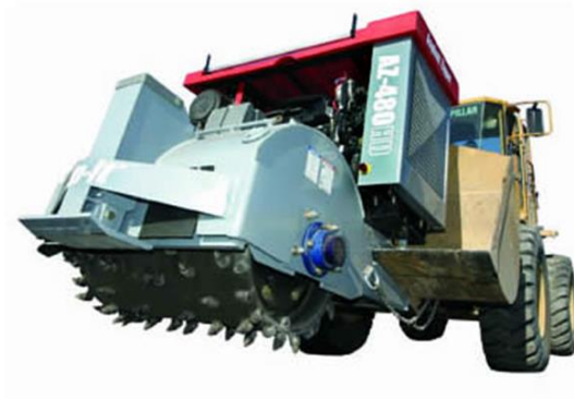
Рис. 3. Навесная фреза Asphalt Zipper AZ-480HD к погрузчику
