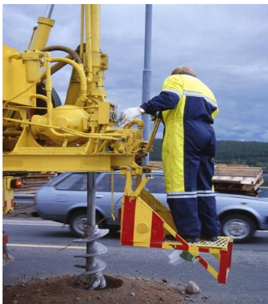
Рис. 1. Взятие пробы при помощи спец машин
