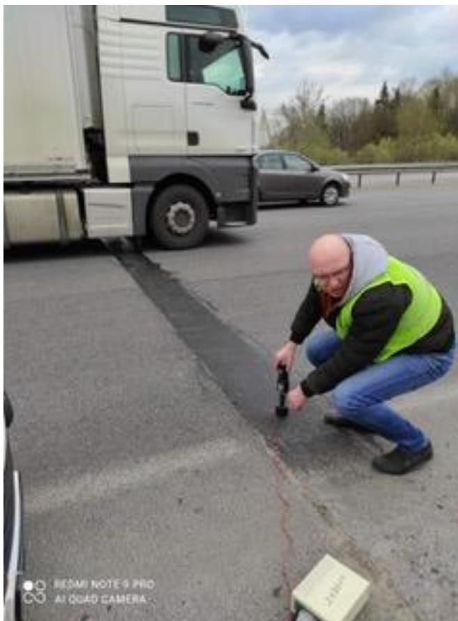
Рис. 4. Исследование с помощью прибора ИПМ -1 деформационных характеристик
