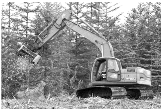
Рис.8. Рабочий орган – мульчер, смонтированный на одноковшовом экскаваторе
