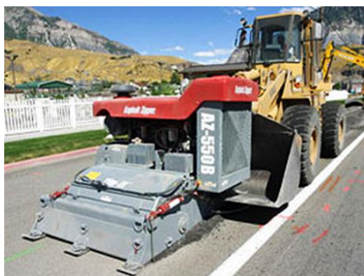
Рис. 4. Навесная фреза Asphalt Zipper AZ-550B к погрузчику
