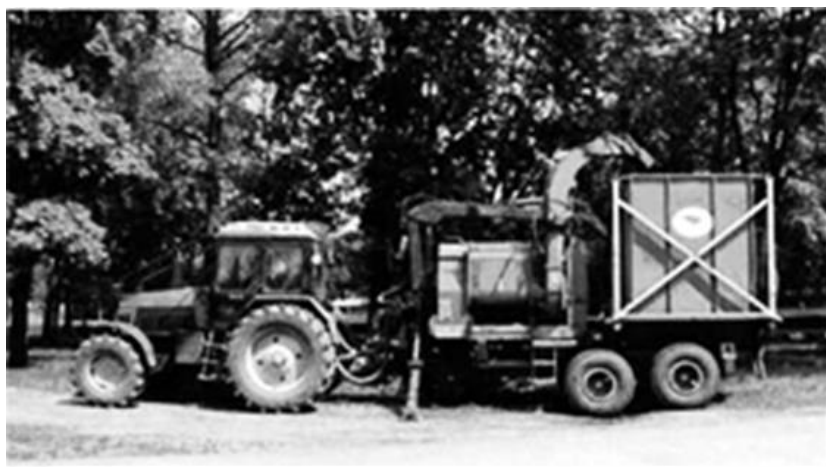
Рис. 4. Рубильная машина, оборудованная бункром-накопителем
