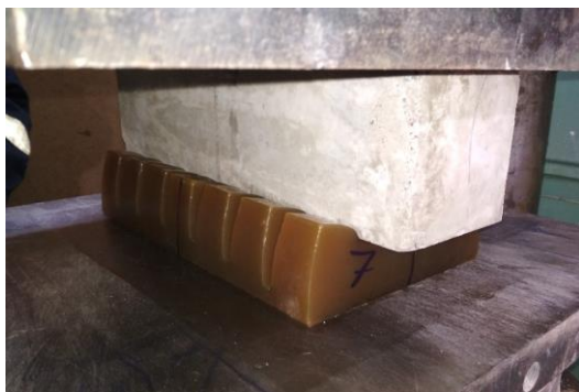
Рис. 9. Испытание попарной части на локальное сжатие. Пресс П-250. Испытуемый образец № 7
