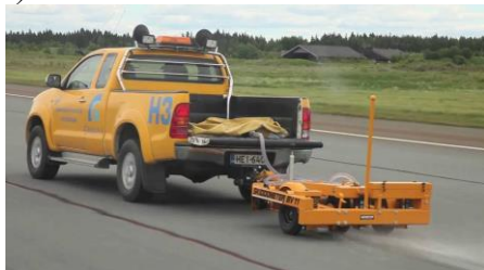
Рис. 1. Установки для оценки коэффициента сцепления блокированием колеса
