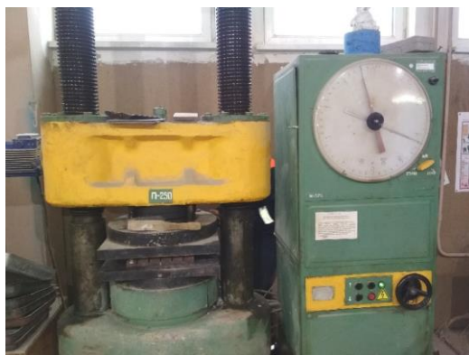
Рис. 1. Испытание попарной части. Пресс П-250. Испытуемый образец № 2
