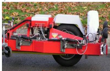
Рис. 1. Установки для оценки коэффициента сцепления блокированием колеса
