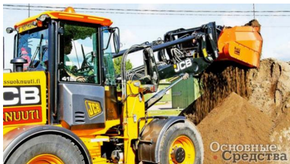
Рис. 12. Ковш-дробилка JCB CB60
