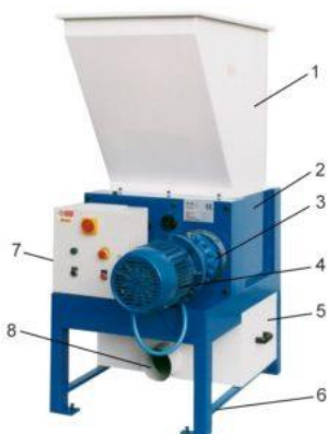
Рис. 4. Внешний вид четырехвального шредера 1-загрузочный бункер; 2-корпус установки; 3-редуктор; 4-мотор; 5-накопительный бак; 6-рама; 7-панель управления; 8-вывод под аспирацию.
