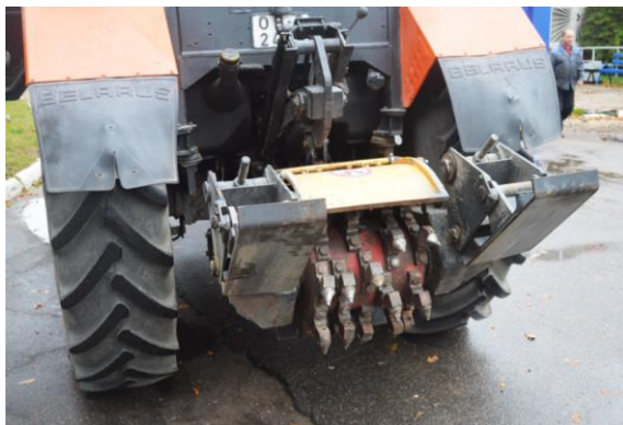
Рис. 7. Машина фрезерная ДЭМ-121 производства СП «Дорэлектромаш»
