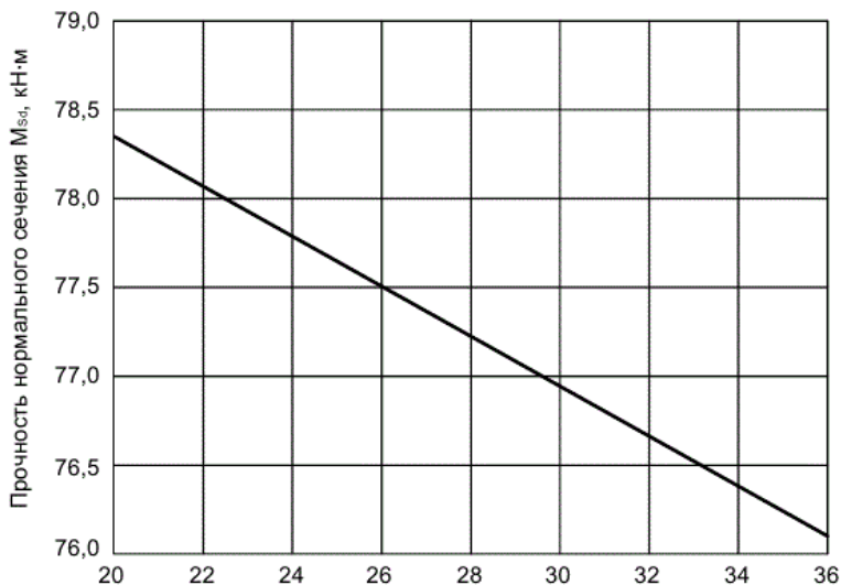
Рисунок 2 – толщина защитного слоя бетона.
