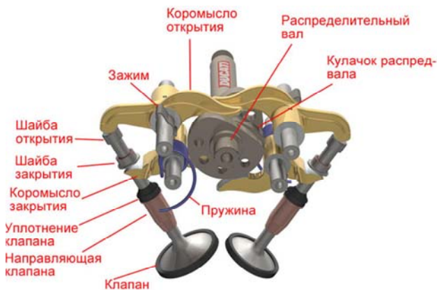
Рис. 5.6. Десмодромный газораспределительный механизм
