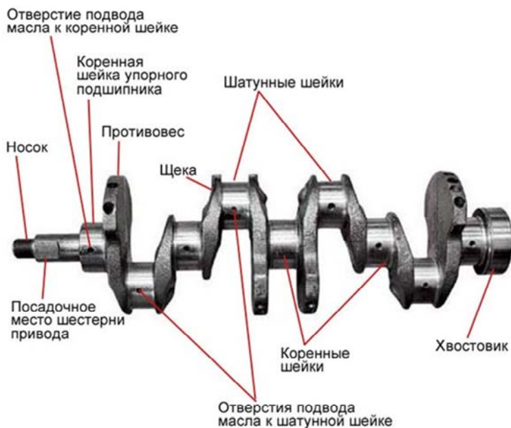
Рис. 4.2. Коленчатый вал ДВС
