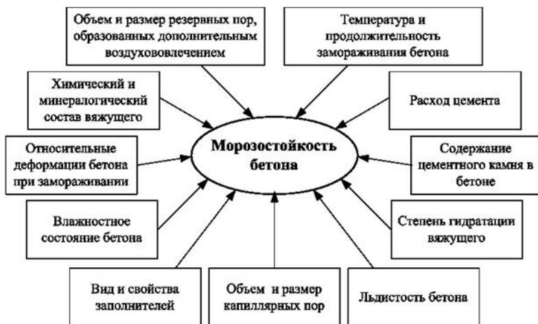
Рис. 1.7. Основные факторы, определяющие морозостойкость бетона
