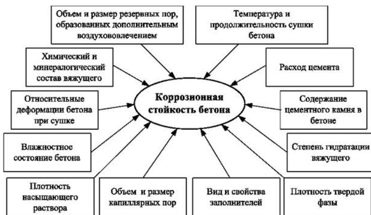
Рис. 1.8. Основные факторы, определяющие солестойкость бетона
