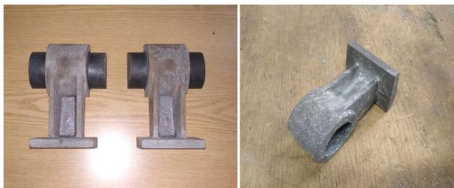
Рис. 5.15. Деревянная модель и отливка
