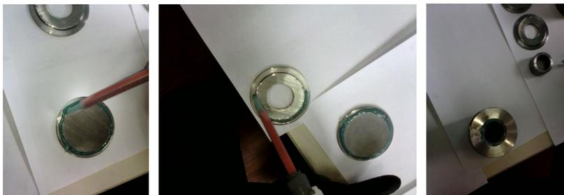
Рис. 4.8. Поэтапный процесс склеивания фильтра
