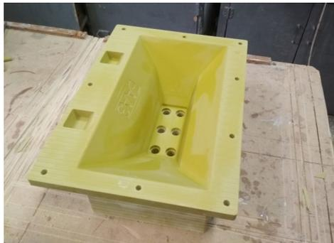
Рис. 5.27. Модель отливки «Корпус»
