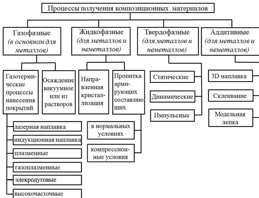
Рис. 6.1. Классификация процессов получения композиционных материалов
