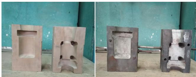
Рис. 5.16. Модели из пластика и отливки
