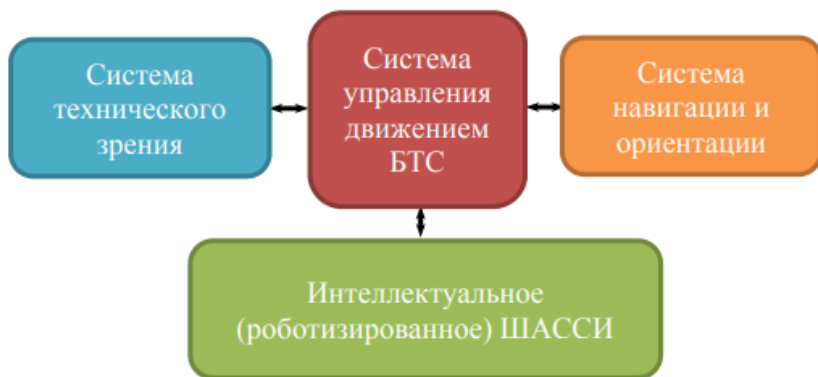
Рисунок 1 – Типовая функциональная схема основных подсистем автоматической системы управления БТС.
