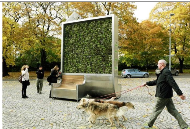
Рисунок 8. «CITYTREE» представляет собой отдельно стоящий вертикальный блок, покрытый мхом и лишайниками. Он поглощает вредные загрязнители, диоксид азота и озона как 275 деревьев. Занимает на 99% меньше места и может быть установлено всего за 5% от стоимости посадки деревьев. Состояние почвы и растений, уровень питательных веществ контролируются и регулируются в режиме онлайн.
