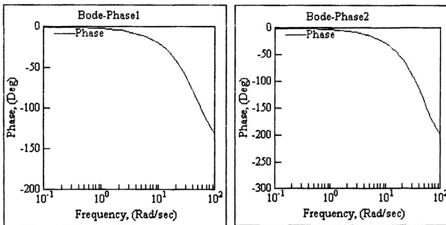
Рис. 7. Фазово-частотные характеристики фильтров 2 и 3 порядков
