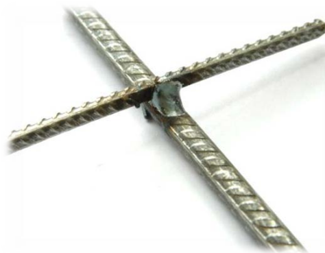
Рис. 1. Крестообразное соединение арматуры диаметрами 4 и 6 мм, выполненное дуговой сваркой полуавтоматом в среде активного газа \text{CO}_2
