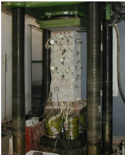
Рис. 3. Общий вид испытаний нагружением опытных фрагментов колонн
