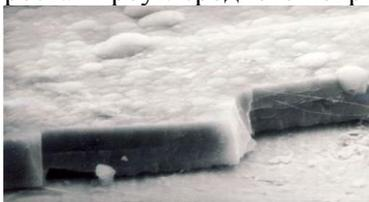
Рисунок 2 – Электронно-микроскопическое изображение структуры скола сформированного пироуглеродного покрытия
