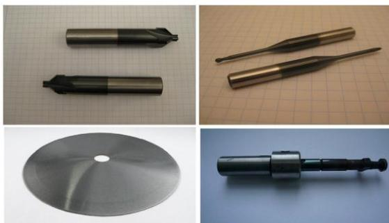
Рисунок 2 – Износостойкие покрытия
