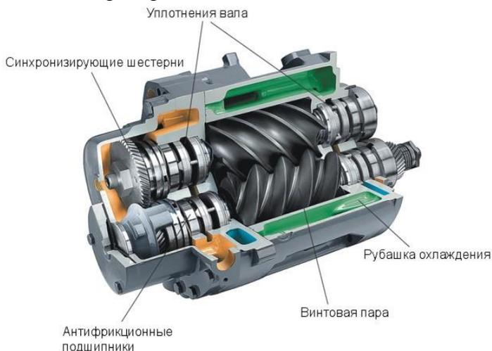
Соединение винтовых роторов
