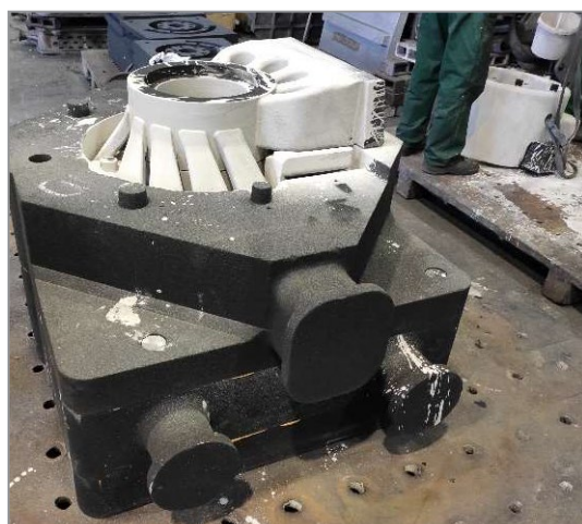
Рис. 12. Окраска стержней, начало сборки
