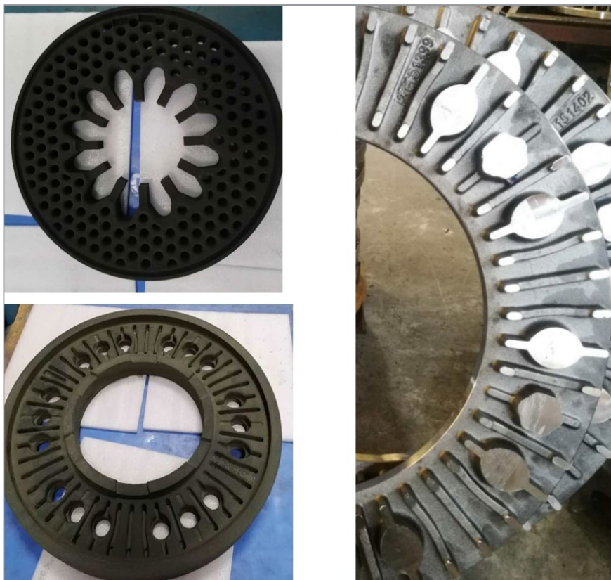
Рис 6. Тормозной фланец для скоростного поезда. Форма (слева) и готовая отливка
