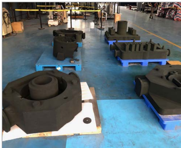
Рис. 9. Напечатанные фрагменты формы
