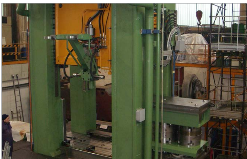
Рис. 8. Гидравлический пресс с автоматизированной заменой штампов в составе автоматизированной линии поставки компании Murgato S.p.A на Минском подшипниковом заводе
