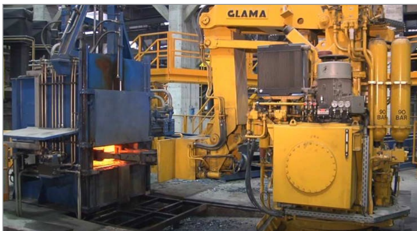
Рис. 7. Установка гидросбива окалины водой в составе автоматизированной линии по изготовлению железнодорожных колес на предприятии Lucchini (Италия)
