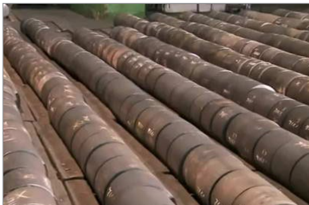
Рис. 5. Накопитель заготовок в составе автоматизированной линии для изготовления железнодорожных колес на Выксунском металлургическом заводе (Россия)
